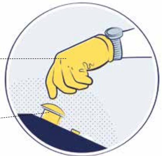
Die schnittfesten Arbeitshandschuhe bestehen aus PA, Glasfaser und PE mit sehr langen Molekülketten. Die Gummibeschichtung besteht aus Nitril.
